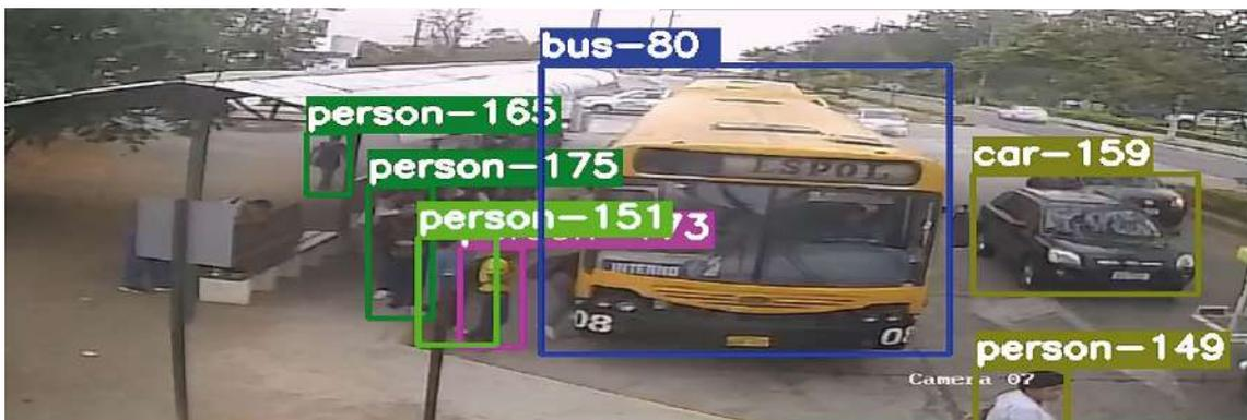
*Ilustración 2: Detección de vehículos y personas mediante técnicas de visión por computador*
