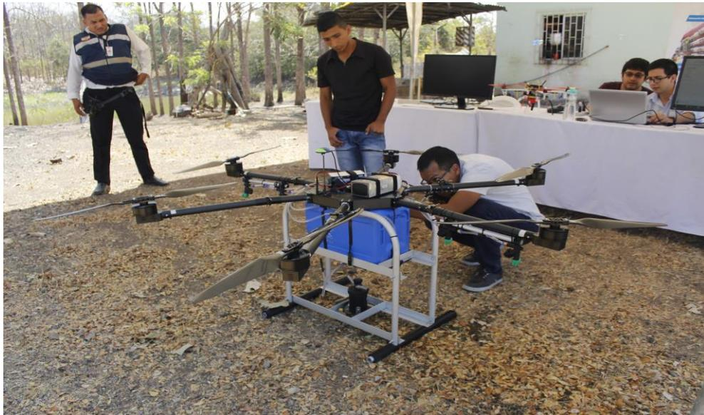
*Ilustración 8 Pruebas de campo del proyecto de investigación “Dron Agrícola Multifuncional: Pulverizador y Esparcidor” patrocinado por la empresa Joflosa S.A.*
